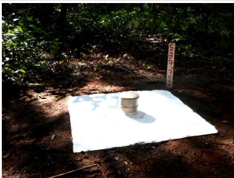
Figura 06: Sondas instaladas e já em medições piezométricas
