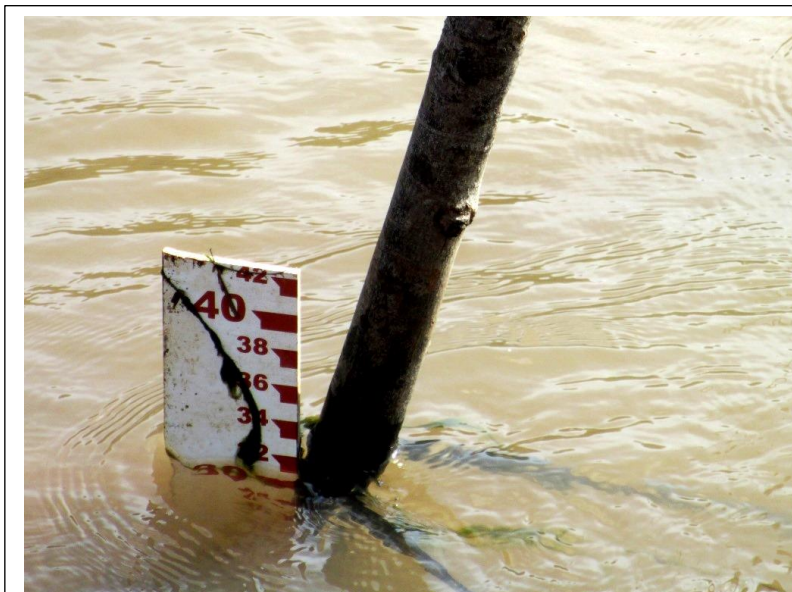
Figura 08: Réguas limnimétricas medem o nível das águas do rio
