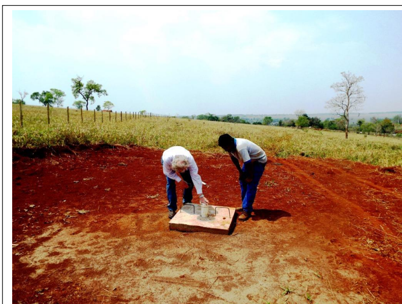
Figura 05: Poço de sondagem na Margem Esquerda
